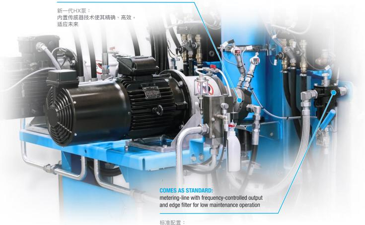
你准配直。 具有流量变频控制和刃式过滤器的发泡单元,实现 低维护操作
